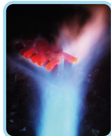
Der Ventilstock beim Hartlöten
